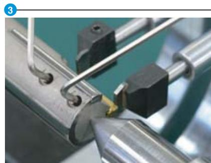
• Отрегулируйте положение режущей пластины при помощи регулировочных винтов :
