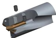
Установка и регулировка длины рабочей части сверла винтом регулировочным
